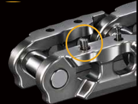
螺栓断在链节内部
